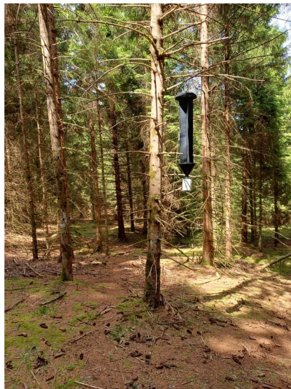
Trappola "Cross-vane" con feromoni per la ricerca di specie di Monochamus non europee (foto del Servizio Fitosanitario della Lombardia).
