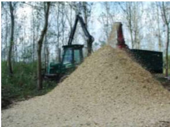
La ramaglia viene cippata sul pioppeto e portata nella centrale energetica più vicina. (foto dott. Massimo Noris)
