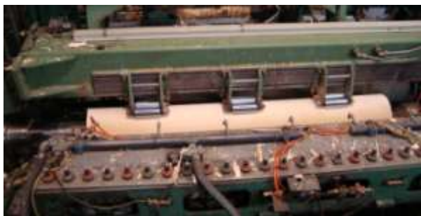
Tronco nella sfogliatrice. (Garnica Plywood Group, S.A.)
