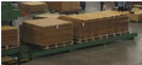
Accatastato di fogli di pioppo essiccati, pronti per l'incollatrice (foto Angelo Cremona S.p.A.)
