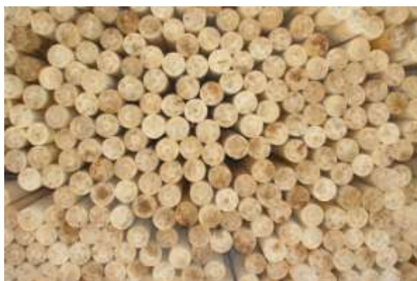
I tondelli, il cuore del tronco, per le sue caratteristiche dimensionali fisse, viene solitamente usato in segheria con uno scarto minimo. (foto Angelo Cremona S.p.A.)
