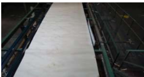
Foglio continuo di legno che esce della sfogliatrice. (foto Garnica Plywood Group, S.A.)
