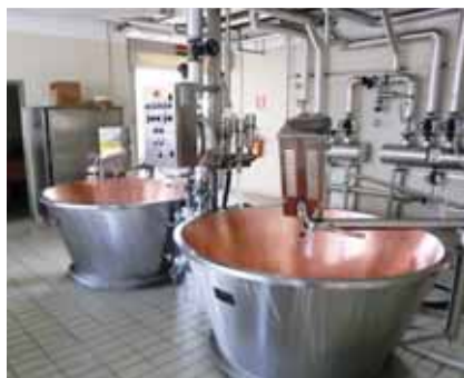
Figura 76. L-FS, le 2 caldaie da 1.000 litri ciascuna impiegate nel 2° modulo
