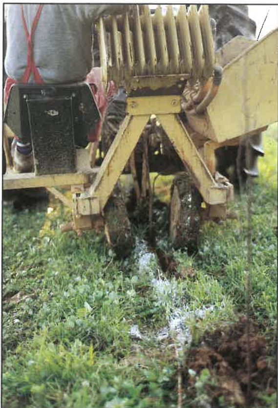
Trapiantatrice Quickwood: su terreni pianeggianti e non compattati è possibile l'impiego di questa attrezzatura che riduce notevolmente i tempi della messa a dimora.
