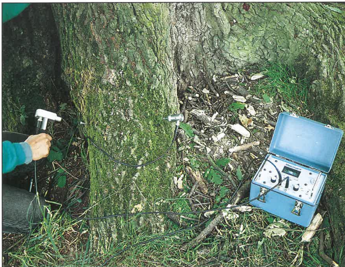
Il martello ad impulso misura il tempo necessario di percorso di un'onda sonora. Tale tempo diminuisce per la presenza di carie o fenditure nel legno analizzato. Valori di riferimento servono per l'interpretazione dei risultati (foto Coop. Demetra).
